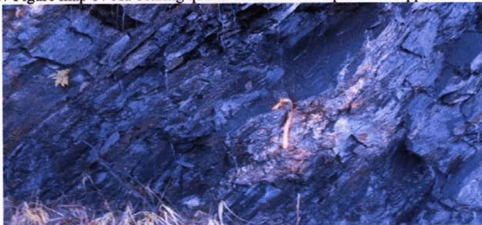
Photo I / Figure map 6 / Au bearing quartz vein / ALS sample I – 1.57ppm Au
